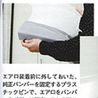
エアロ装着前に外しておいた、純正バンパーを固定するプラスチックピンで、エアロをバンパーに固定。これを両サイド行えれば作業完了。
