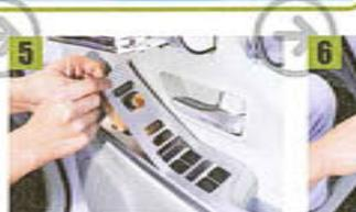
剥離紙を片方ずつそとと剥がし、ずれがないかを確認しながらシート全体を貼り付ける。
