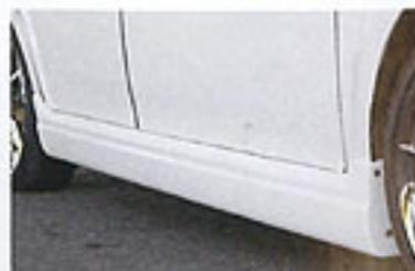
直線的ラインでシンプルに描いたサイドステップ。リアスポイラーと同じ高さにプレスラインを入れ、統一感を持たせる。
