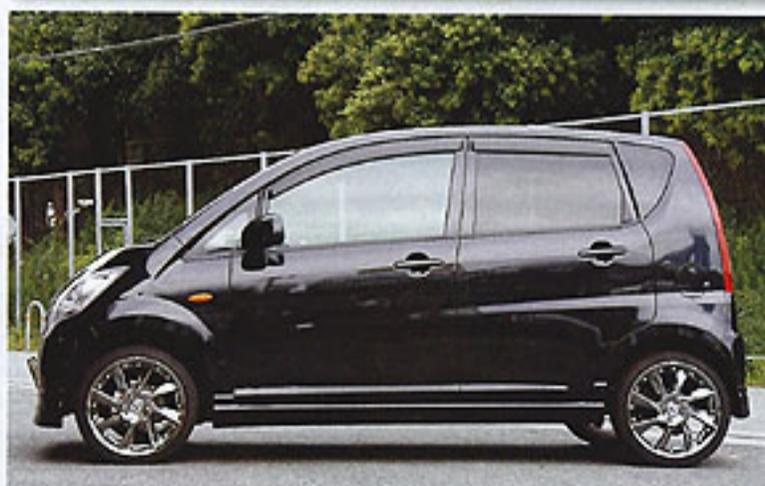
上はRS6Rで測定した際のムーヴを純正の足まわりのに戻したものの、注意したいのは、他メーカーのアーチ高との比較には使えない点。履いているタイヤサイズが違うし、クルマには個体差があるので、純正アーチ高が同じとは限らないためだ。この純正の姿は、車高調を装着した際の、見た目の印象を知るための基準としてだけ考えよう。
