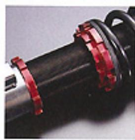
シュピーゲル車高調は全長調整式を採用。通常の車高調と異なるピロアッパーマウントを標準で装着する。ピロアッパーマウントの調整で、キャンバー角を自由に調整できる。
