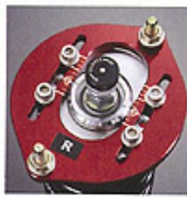
ピロアッパーマウントは、キャンバー角を自由に調整できる。ピロアッパーマウントを標準状態で装着すると、キャンバー角が不足しないのが特徴だ。アッパー側の操作で、キャンバー角を自由に調整できる。
