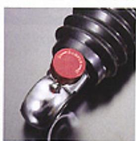
シュピーゲルプロスペックワゴンの全長調整式は、前後とも減衰力調整機構を標準で採用。フロントは30段、リアは20段の減衰力調整機構を採用。減衰力調整機構は、減衰力調整機構を採用。減衰力調整機構を採用。
