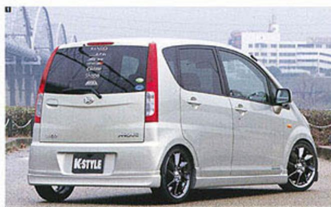
①延長はフロントが下に2cm。前方へはほんのわずが、リアが下に1.5cm。後方へはゼロ。限られたサイズの中で造形美が光る。ムーヴ用はナンバーポケットのくぼみの分、リアハーフのデザインにも少し違いが。②サイドテーブルは「乱人流」ブランド。使いやすく圧迫感もなし。標準カラー1万3440円。特注カラー1万5540円。レザー調素材の「LUXシリーズ」ダッシュボードテーブルは2万7900円。③フロアマットはベロアとマーカントの2タイプ。④運動感のあるホイールが元来に華をそえる。⑤純正のオーバーフェンダーデザインを生かすあしらい。リップはえぐるような造形でボディとのフィット感を強調。⑥巧みな曲線でエアロだけが浮かないようにデザイン。⑦曲線を多用したボディラインと調和させたムーヴカスタム用。バンパーに元々あるラインを生かし、さらにその下にもラインを加えてメリハリ感を出している。
