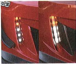
デザイン性を追求した結果、ウインカー&デイルイトはタテ型のオリジナルLEDを製作。丸穴タイプと露出タイプの2タイプを用意する
