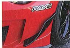
「サーキットでのフロントの接地性確保には不可欠」として、オプションで3D形状を取り入れた専用のカナードもリリースしている
