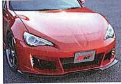
ノーマル比20mmのロングノーズ化を実施。ノーマルのボディラインを継承しながら、違和感なく躍動的なフォルムに仕上げている
