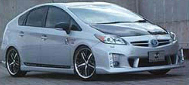
30プリウスには純正で3種類のサイズが存在する。ホイール口径でいうと、ツーリングセレクション系の17インチ、G/S/Lグレードの15インチ。ボディサイズを考慮すると、インチアップの場合、18インチ以上が一般的と言えるだろう。P.C.D.100の5穴とちょっと特殊なサイズなのだが、各メーカーともにプリウス専用と対応として5H/100を設定しているし、レガシィ系と同P.C.D.なので、特に心配する必要はない。ソライチセッティングにはインセット+40~45が目安となる。
