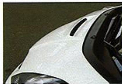
FRP製のボンネットは一見純正っぽいですが、ダクトを設けてさりげなく差を付ける。カーボン仕様もあり。
