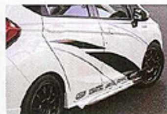
プリスターライクなプレスラインにはシンプルデザインだと物足りない。視線を下方に向け下げるべくディフューザーデザインのサイドステップとした
