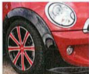
片側約25ミリのワイド化を実現するオバフェンは、フロントのカナードとセット品。
